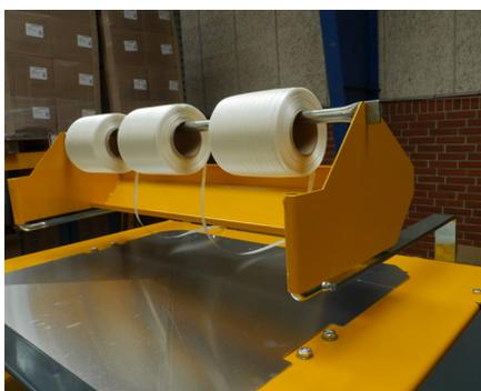
Les porte-attaches montés sur le haut de la machine évitent d'avoir à accéder à l'arrière.
