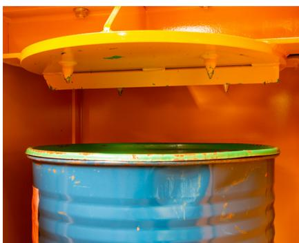
Des pointes montées sous la plaque de pression percent le fût et éliminent l'air.
