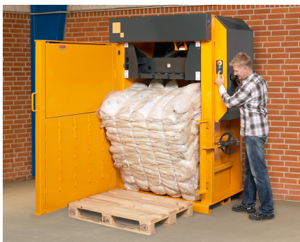
Automatischer Auswurf der Rohstoffballen.
