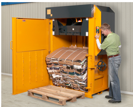
Automatischer Auswurf der Rohstoffballen.
