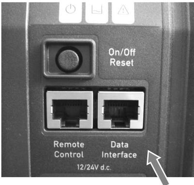
4. Schließen Sie den RJ45 Stecker des Datenkabels an der Datenschnittstelle (Data Interface) Ihrer EFOY Pro Brennstoffzelle an.
