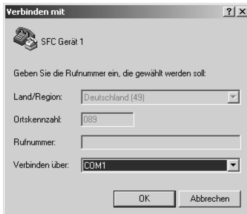
Wählen Sie im Menü „**Verbinden über**“ die Schnittstelle aus an der Sie die den Interface Adapter angeschlossen haben z.B. COM1.
