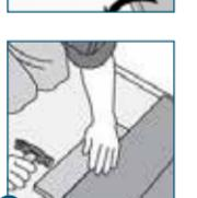
7. Ved lægningen kan der opstå mindre fuger imellem brædderne. Disse elimineres ved hjælp af en hammer/slakglods og et trækjern (billede 8).
