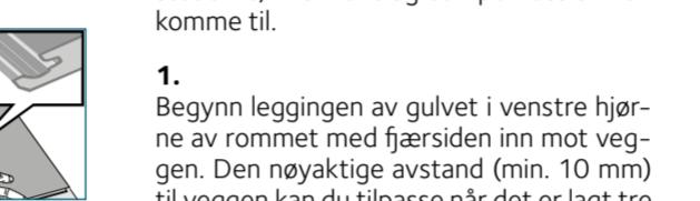
1. Begynn leggingen av gulvet i venstre hjørne av rommet med fjærsiden inn mot veggen. Den nøyaktige avstanden (min. 10 mm) til veggen kan tilpasses når tre rader har lagts (bilde 2).
