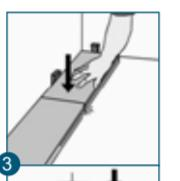
2. Næste bræt lægges tæt op ad nabobrættet, og presses/klemmes ned indtil låsen klikker (billede 3). Læg hele første række på denne måde – med undtagelse af...
