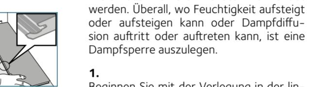
1. Beginnen Sie mit der Verlegung in der linken Ecke des Raumes, wobei die Federseite zur Wand gerichtet ist. Den genauen Abstand (min. 10 mm) zur Wand können Sie anpassen, nachdem drei Reihen verlegt sind (Abb. 2).
