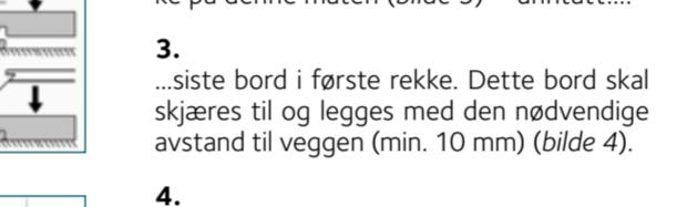
3. ...siste bord i første rekke. Dette bord skal skjæres til og legges med den nødvendige avstanden til veggen (min. 10 mm) (bild 4).
