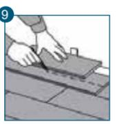
9. Skær den sidste række af gulvbrædder til med den nødvendige afstand til væggen (billede 9), og saml denne med den næstsidste række. Monter herefter fodlisterne. Der skal udføres dilatationsfuge i døråbninger og ved større arealer. Max. 8 x 12 m. 12 m langs af brædderne.
