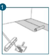
Gulvet lægges svømmende. Brædderne sammenføjes uden brug af lim. Ved monteringen skal der løbende anvendes brædder fra flere pakker for at sikre et harmonisk farve- og nuancespillet. Der skal være fugtspærre alle steder, hvor der er, eller kan forekomme, fugtopstigning eller dampdiffusion.
