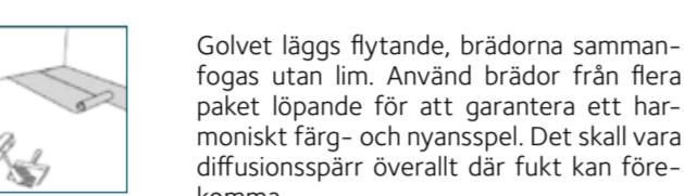
Gulvet läggs flytande, brädorna sammefogas utan bruk av lim. Använd bräder från flera paket löpande för att garantera ett harmoniskt färg- och nyansspel. Det ska vara diffusionspär överallt där fukt kan förekomma.
