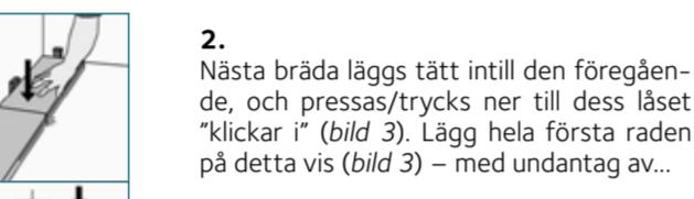
2. Nästa bräda läggs tätt intill den föregående, och pressas/trycks ner till dess låset "klickar" (bild 3). Lägg hele första raden på detta vis (bild 3) – med undantag av...
