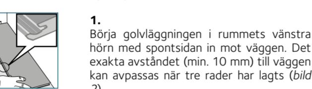
1. Börja gulvlägningen i rummets vänstra hörn med spontsidan in mot väggen. Den nogräfte avståndet (min. 10 mm) till väggen kan avpassas när tre rader har lagts (bild 2).
