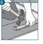
8. Tilpas parketbræddernes afstand til væggen, når de tre første rækker er lagt. Anbring kiler mellem gulv og væg. Afstanden til væggen skal være min. 10 mm.
