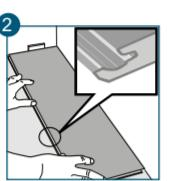
1. Begynd gulvlægningen i rummets venstre hjørne med fersiden ind mod væggen. Den nøjagtige afstand (min. 10 mm) til væggen kan du tilpasse, når der er lagt tre rækker (billede 2).
